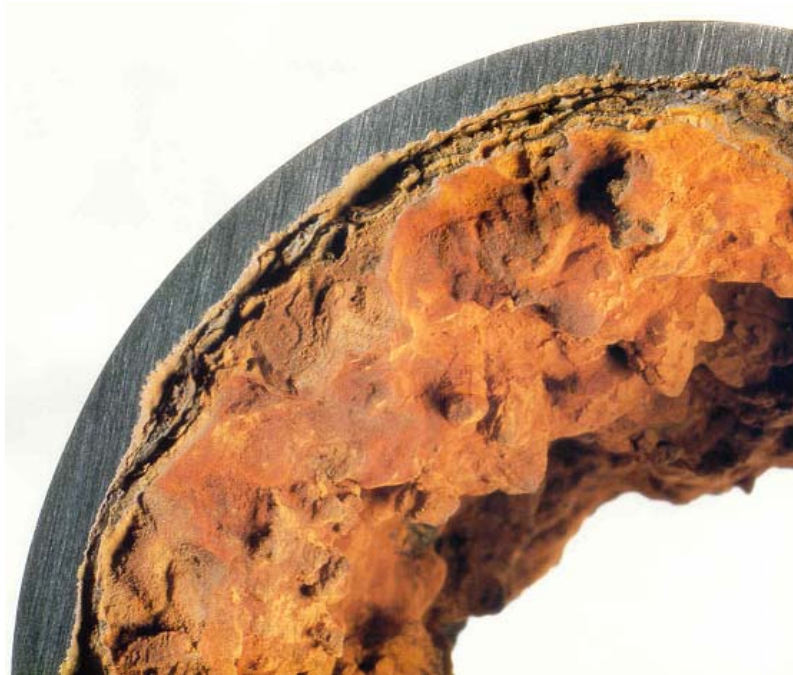
Figura 2 – Ilustração de corrosão no interior das tubagens [1].
