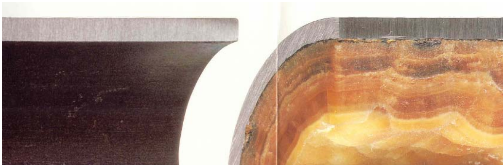
Figura 4 – Ilustração de incrustação num tubo e um tubo limpo [1].
